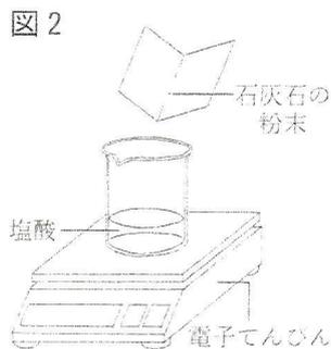
(b) 図2のように、このビーカーを電子てんびんにのせたまま、ビーカーの中に石灰石の粉末 0.5 g を入れてよく混ぜた。しばらく時間が経過した後、ビーカー全体の質量を測定した。
